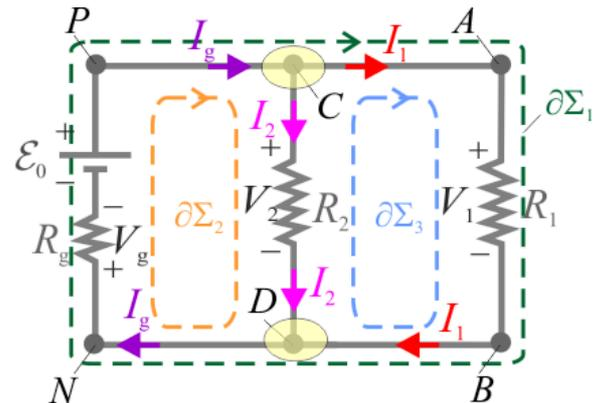
$$2^{\text{a}} \text{ ley de Kirchoff} \rightarrow \begin{cases} \mathcal{E}_0 = V_1 + V_g = I_1 R_1 + I_g R_g; \text{ en } \partial\Sigma_1 \equiv PABN \\ \mathcal{E}_0 = V_2 + V_g = I_2 R_2 + I_g R_g; \text{ en } \partial\Sigma_2 \equiv PCDN \\ 0 = V_1 - V_2 = I_1 R_1 - I_2 R_2; \text{ en } \partial\Sigma_3 \equiv CABD \end{cases}$$
