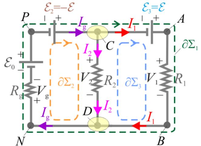
corrientes eléctricas que recorren dicho sistema, en términos de la f.e.m. del generador real,  $\mathcal{E}_0$ , la f.e.m. inducida,  $\mathcal{E} = B_0 a v_0$ , y los valores de las resistencias eléctricas  $R_1 = R_2 = 2 R_g = R$  :
