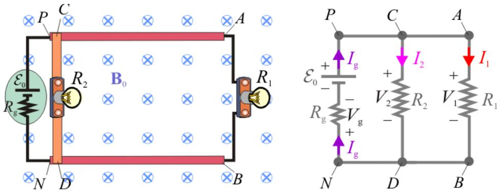
La primera consecuencia de esto es que la diferencia de potencial entre los extremos son idénticas en las tres ramas. Por el contrario, la intensidad de la corriente eléctrica en cada una de las ramas será distinta, en general, estando determinada por dicha diferencia de potencial y el dispositivo localizado en ella:
